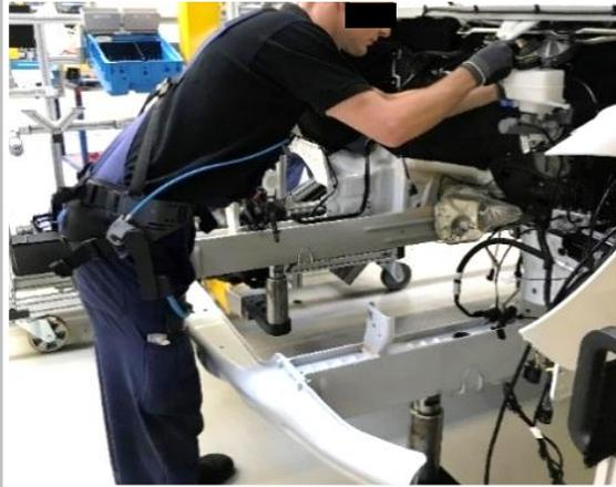
**Exoskelette zur Ermöglichung kurzer Sitzpausen**
