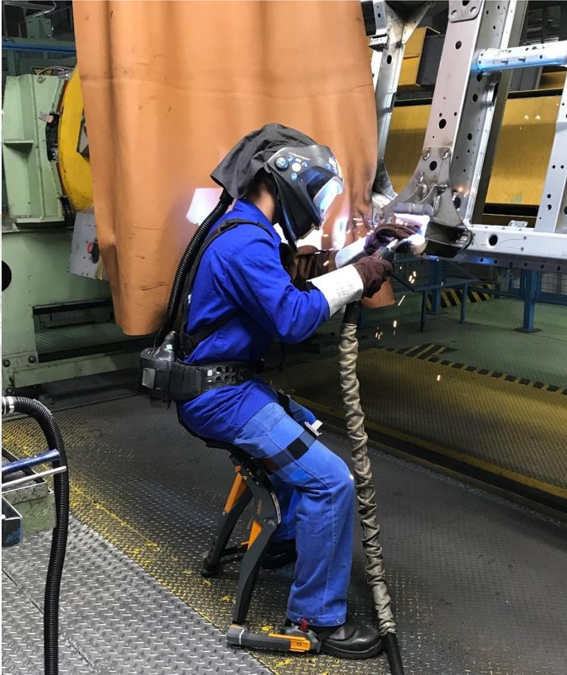
Exoskelette zur Ermöglichung kurzer Sitzpausen
